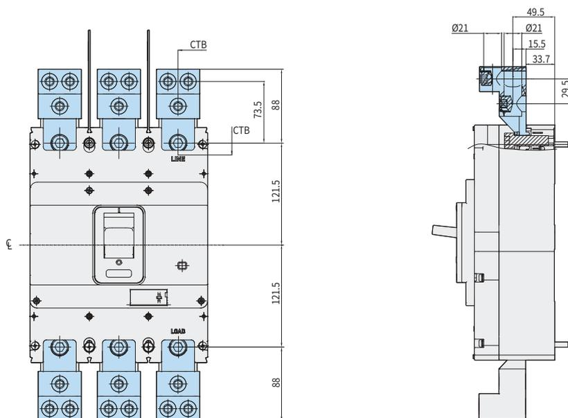
※ При использовании блока зажима провода (СТВ) и отсутствии смонтированной межполюсной перегородки линии/нагрузки изоляционная трубка или изоленга не обеспечивают полной изоляции открытых проводов, что может привести к авариям вторичного короткого замыкания, поэтому межполюсную перегородку надо устанавливать.
