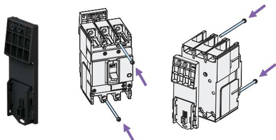
※ При установке переходника DRA заранее снимите заднюю перегородку.
