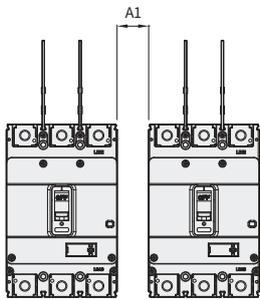
Расстояния сверху/снизу/слева/справа в случае металлической панели рядом
