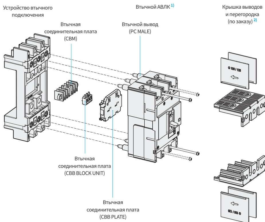
※ 1) Для применения втычного метода подключения нужно использовать втычной АВЛК.
