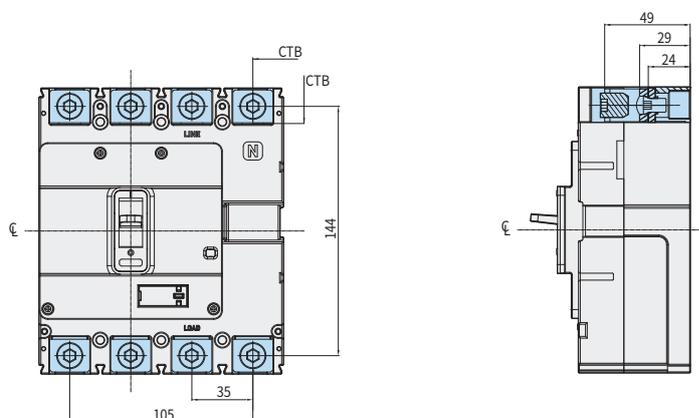
※ При использовании блока зажима провода (CTB) и отсутствии смонтированной межполюсной перегородки линии/нагрузки изоляционная трубка или изолянта не обеспечивают полной изоляции открытых проводов, что может привести к авариям вторичного короткого замыкания, поэтому межполюсную перегородку надо устанавливать.
