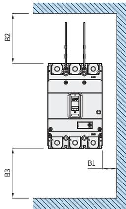
Расстояния спереди/сзади в случае металлической панели рядом
