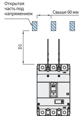
※ В случае использования минимального воздушного зазора (A1 = 0) между выключателями необходимо установить крышку выводов и межполюсную перегородку. Обратите внимание на возможные допуски размеров оболочки шкафа/щита.
