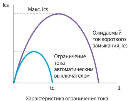
**Различные системы защиты низкого напряжения**
