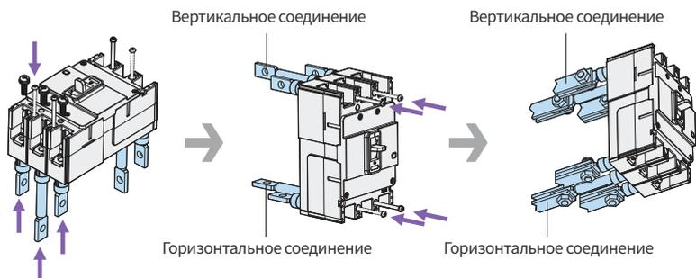
※ При установке заднего вывода (RCT) заранее снимите заднюю перегородку.
