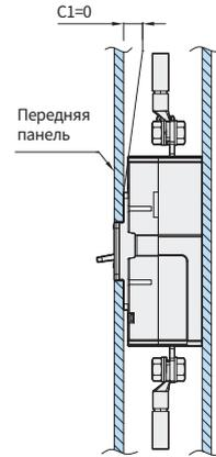
Расстояние до автоматического выключателя в случае открытой части под напряжением
