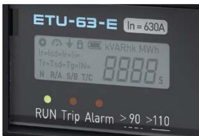
Проверяется текущее состояние на переднем дисплее и статус выключателя на СИД дисплее. (Сигнализация перед отключением).
