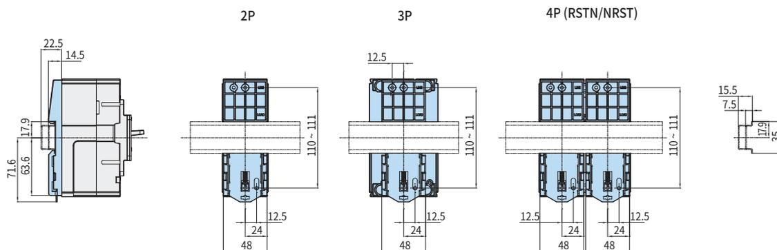
※ При установке переходника на DIN-рейку (DRA) заранее снимите заднюю перегородку.
