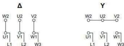
Рисунок А.1.1 - Схема подключения двигателя с соединением фаз обмотки «Δ/У» (шесть выводных концов).
