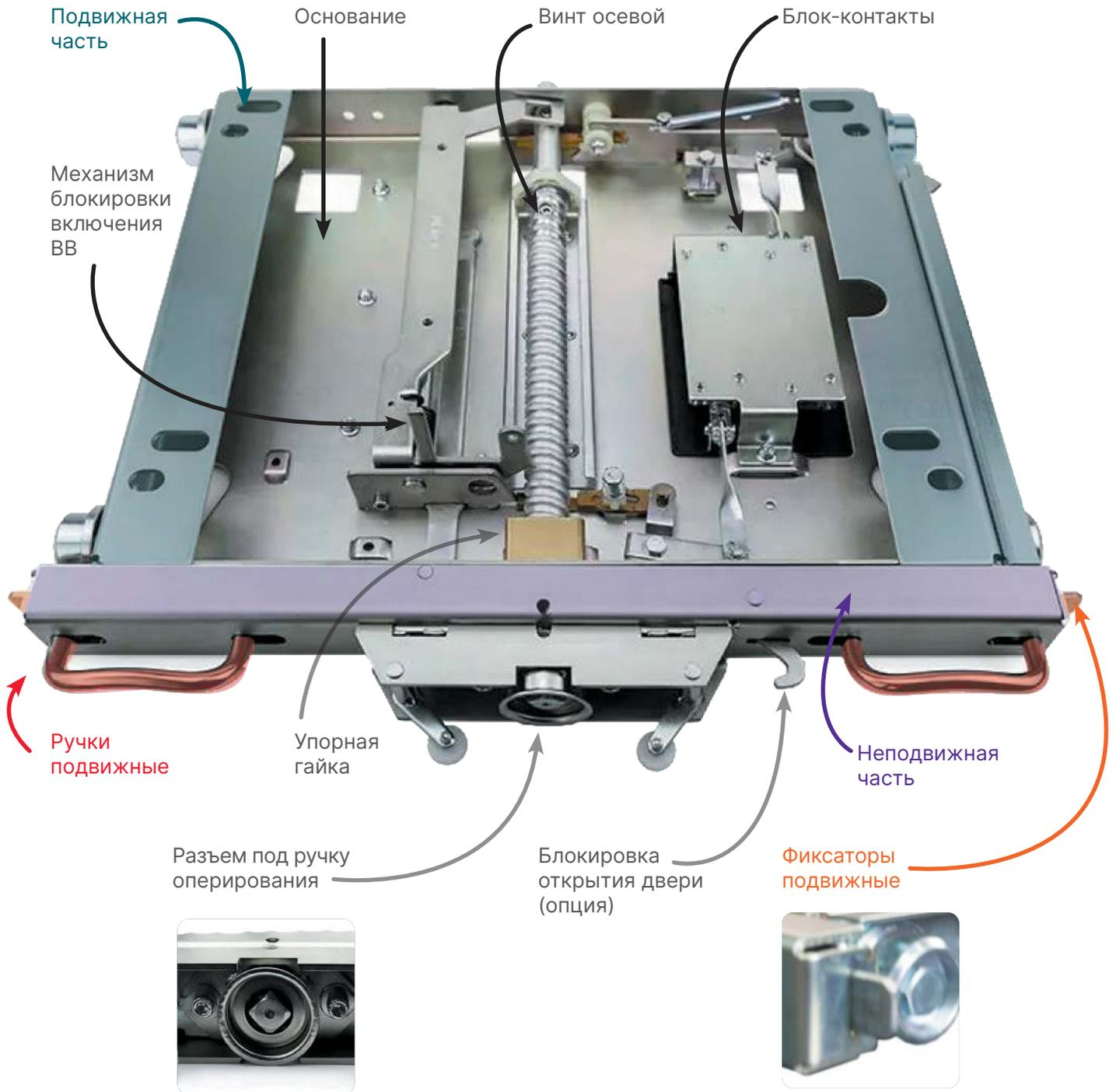
Основными элементами данной конструкции является **неподвижная часть** и **подвижная часть**, на которой смонтирован сам выключатель. Перемещение выключателя на тележку осуществляется за счет вращения осевого винта посредством рукоятки оперирования ВЭ или электродвигателя (в моторизированной тележке). На основании установлены блок-контакты тележки аппаратной, упорная гайка винта и механизм блокировки включения выключателя.
