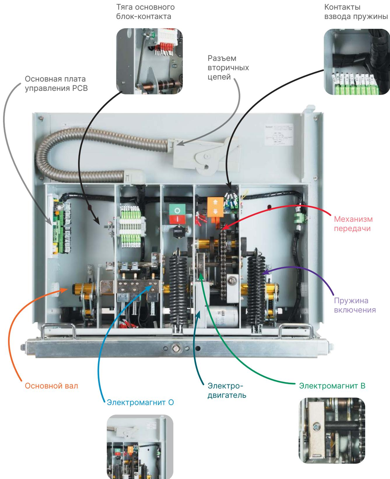
РИСУНОК 6-2. СОСТАВ ПРИВОДА С МОДУЛЬНЫМ ИСПОЛНЕНИЕМ
