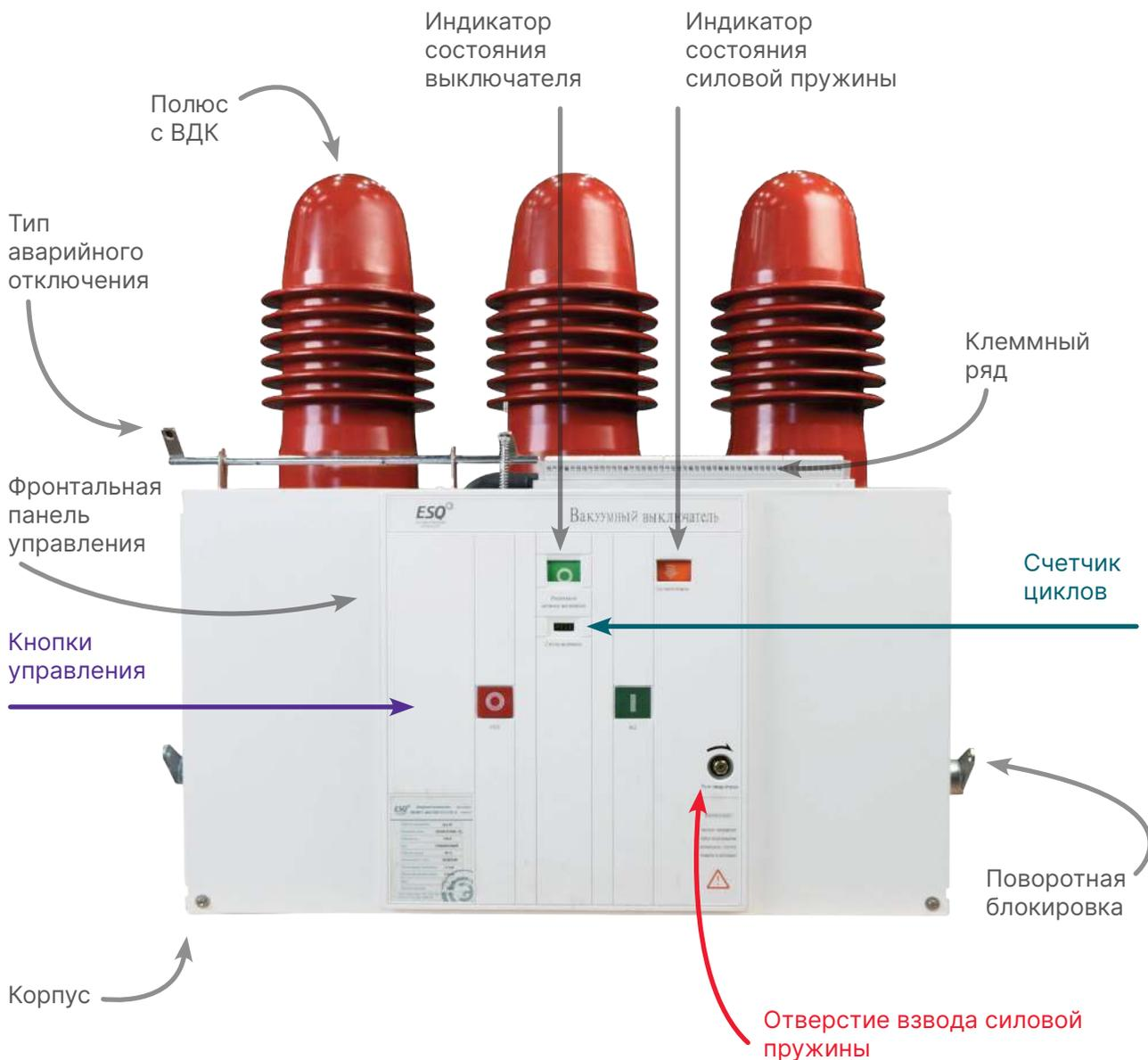
РИСУНОК 2-2. С МОДУЛЬНЫМ ПРИВОДОМ
