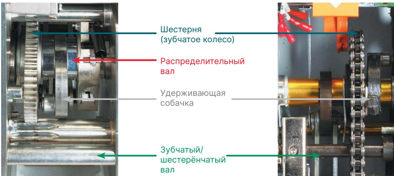
РИСУНОК 8. МЕХАНИЗМ ОТКЛЮЧЕНИЯ
